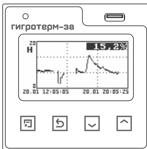
Рисунок 3 – Режим индикации «Точка росы, температура»
