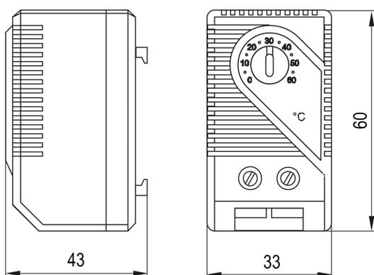
**Рисунок 5.2 – Габаритные размеры МТК-СТ0 и МТК-СТ1**
