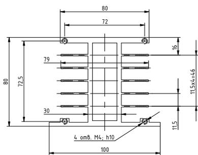
Рисунок 55 – габаритные и установочные размеры радиатора РТР036
