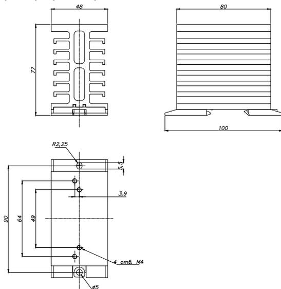
Рисунок 49 – габаритные и установочные размеры радиатора РТР052
