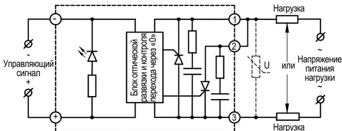
Рисунок 28 – схема подключения ТТП серий GaDH / GwDH-●●●120.ZD3
