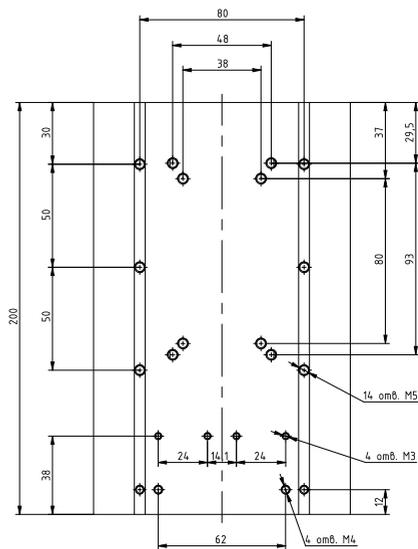
Рисунок 58 – габаритные и установочные размеры радиатора PTP039
