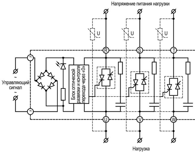
Рисунок 34 – схема подключения ТТР серии HT-●●44.ZA2 ( $\geq 60$  А)
