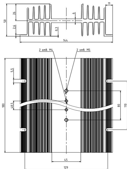
Рисунок 53 – габаритные и установочные размеры радиатора PTP063.1
