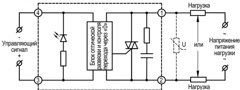
Рисунок 7 – схема подключения ТТР серии MD-●●44.ZD3
