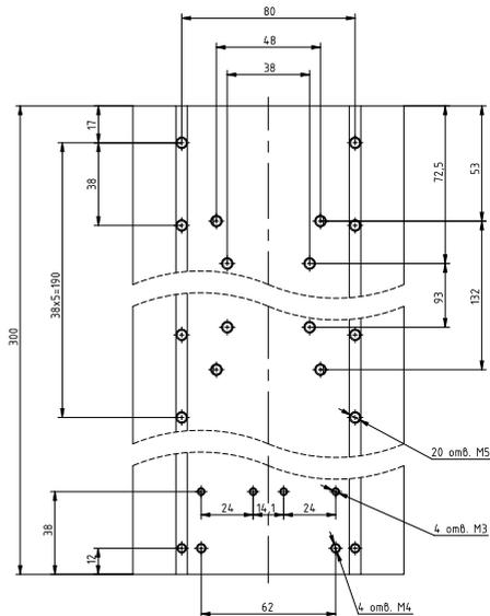
Рисунок 59 – габаритные и установочные размеры радиатора PTP040
