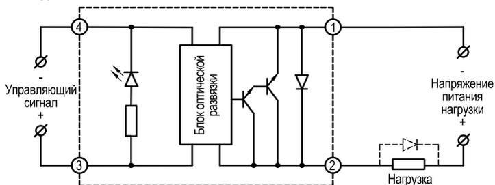
Рисунок 13 – схема подключения ТТР серии HD-●●25.DD3
