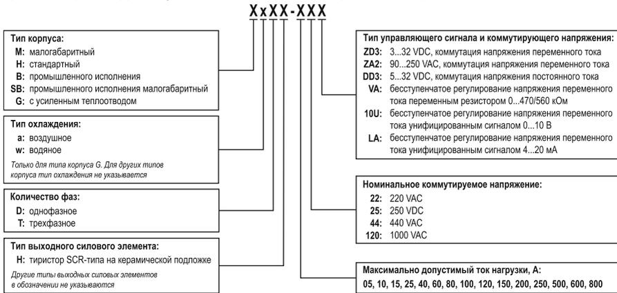
Рисунок 1 – расшифровка условного обозначения ТТР KIPPRIBOR.
