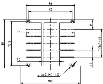
Рисунок 54 – габаритные и установочные размеры радиатора РТР034
