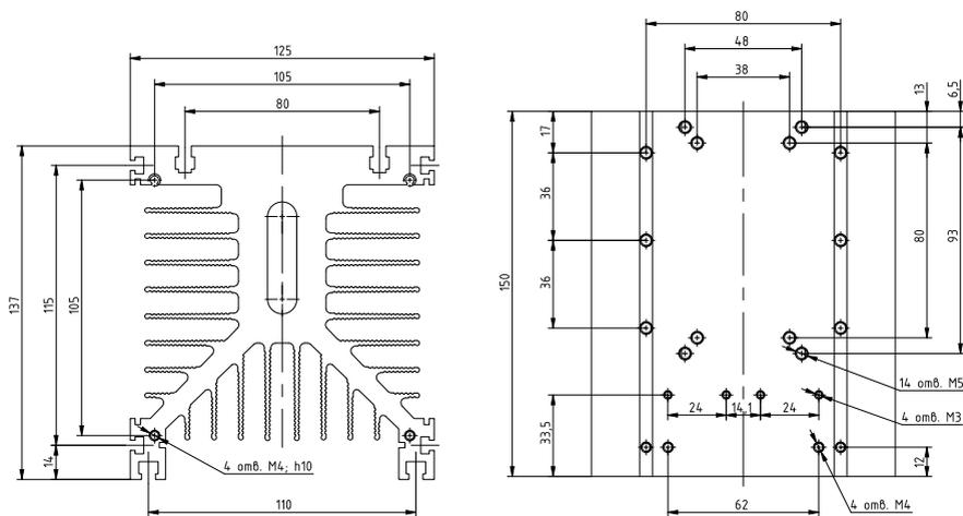
Рисунок 57 – габаритные и установочные размеры радиатора РТР038
