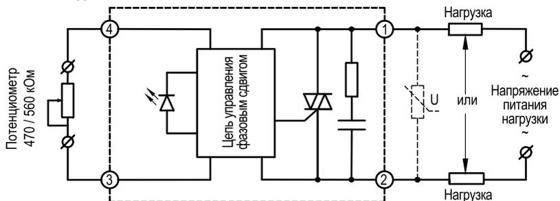
Рисунок 16 – схема подключения ТТП серии HD-●●44.VA
