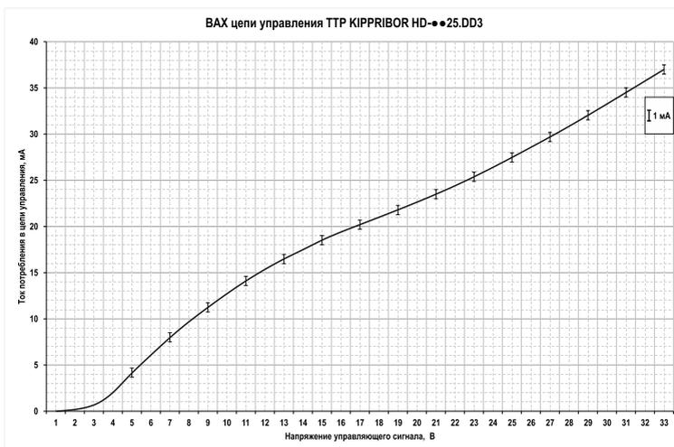
*Рисунок 37 – ВАХ входной цепи ТТР серии HD-●●25.DD3*
