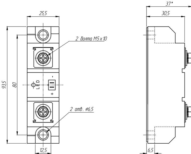
Рисунок 21 – габаритные и установочные размеры ТТП серии SBDH-●●44.ZD3
