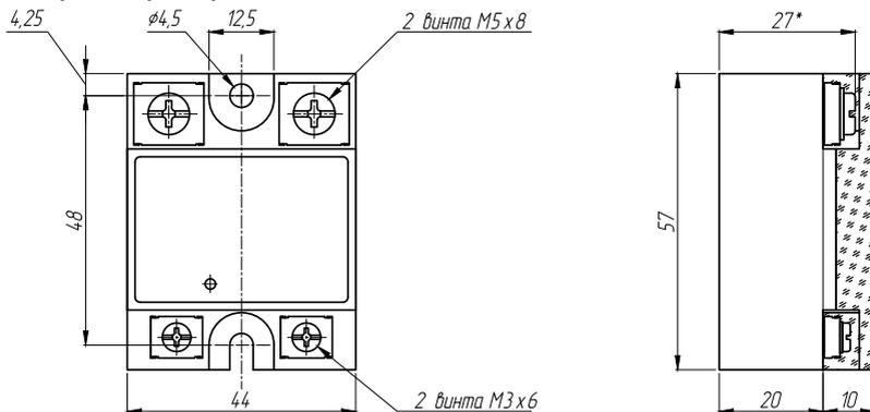
Рисунок 19 – габаритные и установочные размеры ТТП серии HDH-●●44.ZD3
