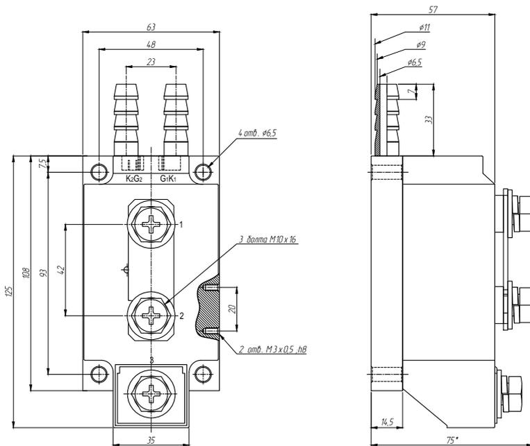
Рисунок 27 – габаритные и установочные размеры ТТП серии GwDH-800120.ZD3
