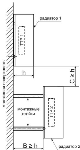
Рисунок 61 – схема размещения ТТР при монтаже друг над другом
