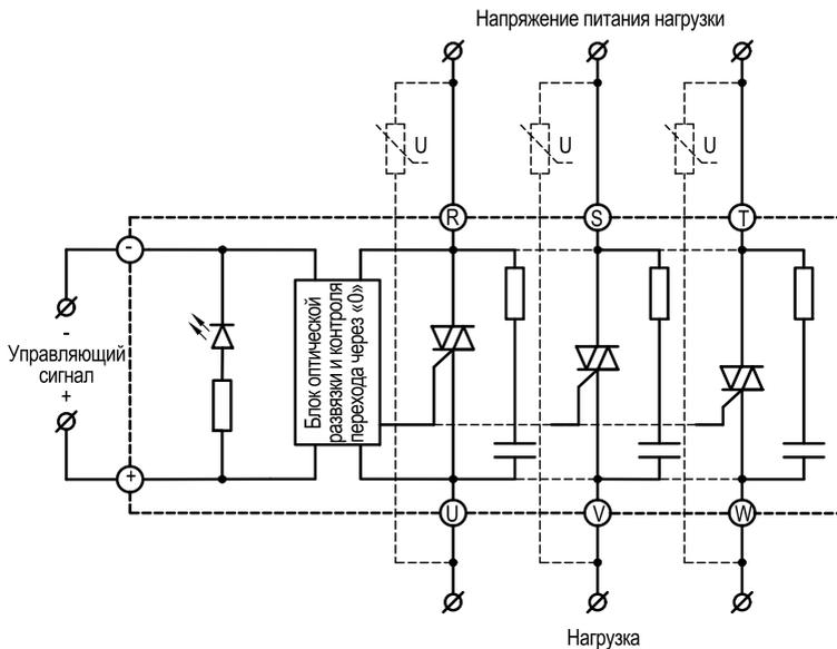
Рисунок 30 – схема подключения ТТП серии HT-●●44.ZD3 ( $\leq 40$  А)
