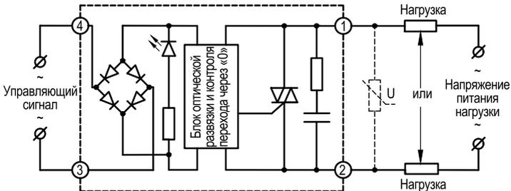
Рисунок 10 – схема подключения ТТР серии HD-●●44.ZA2 (модификации с симисторным выходом)
