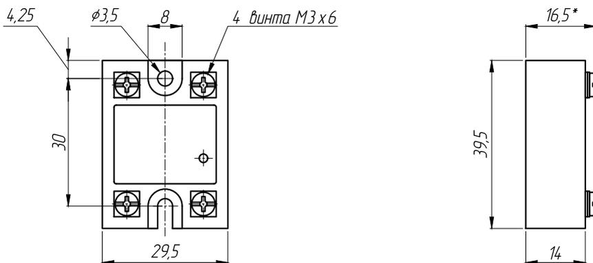
Рисунок 6 – габаритные и установочные размеры ТТР серии MD-●●44.ZD3
