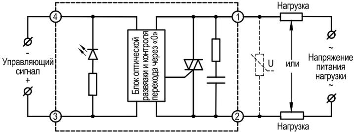
Рисунок 9 – схема подключения ТТР серии HD-●●44.ZD3
