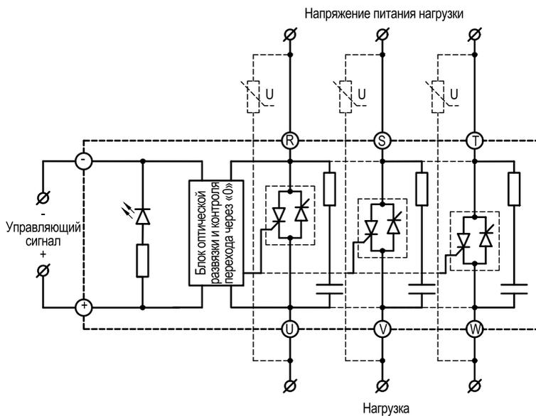
Рисунок 31 – схема подключения ТТР серии HT-●●44.ZD3 (60 и 80 А)
