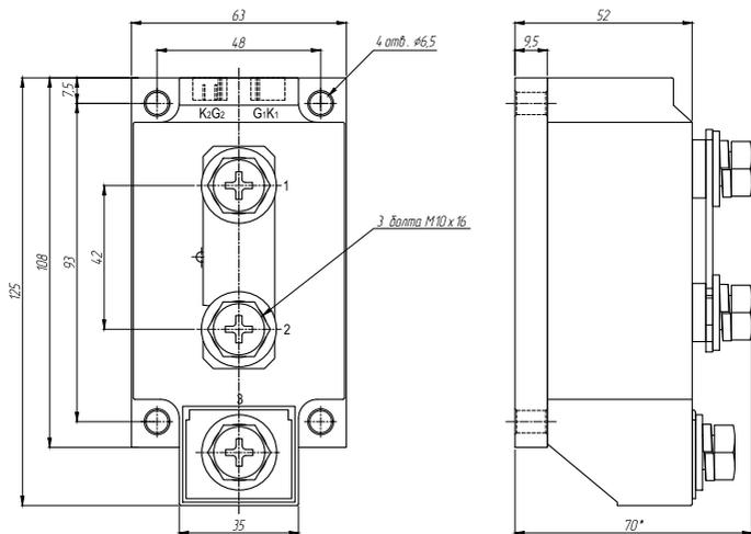
Рисунок 25 – габаритные и установочные размеры ТТР серии GaDH-800120.ZD3
