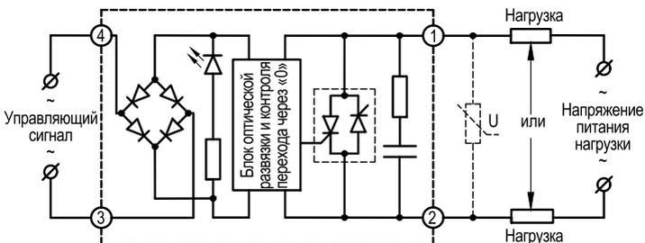
Рисунок 11 – схема подключения ТТР серии HD-●●44.ZA2 (модификации с тиристорным выходом)
