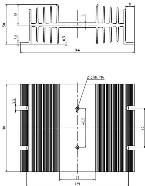
Рисунок 52 – габаритные и установочные размеры радиатора PTP062.1
