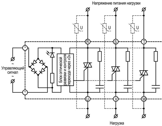
Рисунок 33 – схема подключения ТТР серии HT-●●44.ZA2 ( $\leq 40$  А)
