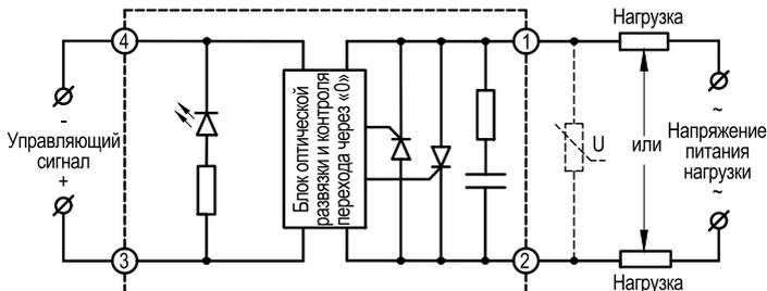
Рисунок 20 – схема подключения ТТП серии HDH-●●44.ZD3
