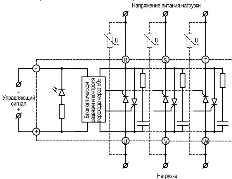
Рисунок 32 – схема подключения ТТР серии HT-●●44.ZD3 ( $\geq 100$  А)
