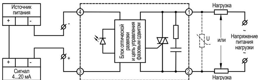
Рисунок 17 – схема подключения ТТП серий HD-●●25.LA
