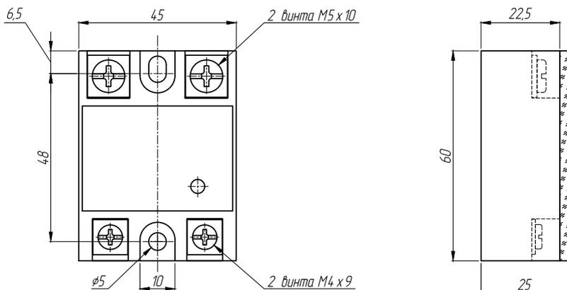
Рисунок 15 – габаритные и установочные размеры ТТП серии HD-●●22.10U
