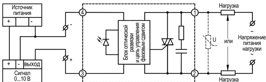
Рисунок 18 – схема подключения ТТР серий HD-●●22.10U
