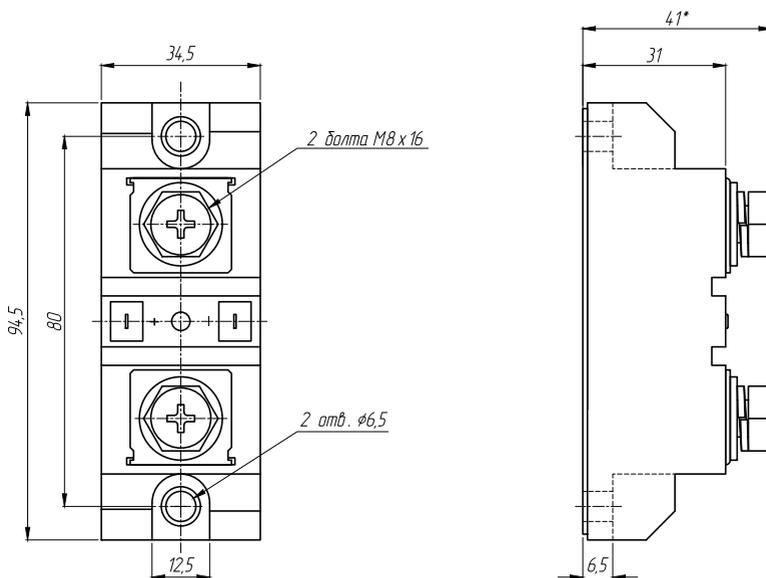
Рисунок 22 – габаритные и установочные размеры ТТР серии BDH-●●44.ZD3
