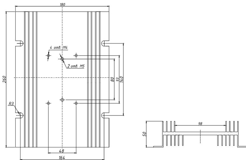
Рисунок 56 – габаритные и установочные размеры радиатора РТР037
