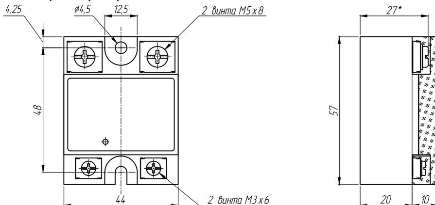
Рисунок 12 – габаритные и установочные размеры ТТР серии HD-●●25.DD3
