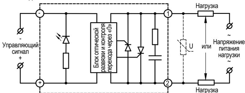
Рисунок 23 – схема подключения ТТР серий BDH / SBDH-●●44.ZD3
